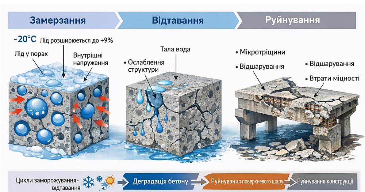
Рисунок 1 — Механізм морозного руйнування бетону
